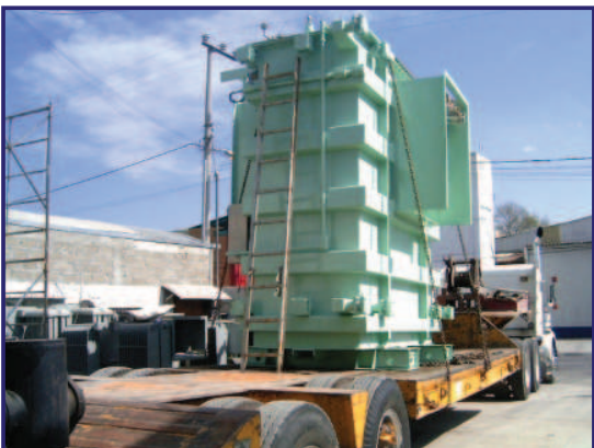
Transformador de 18/24/30 MVA, en 85 kV.
